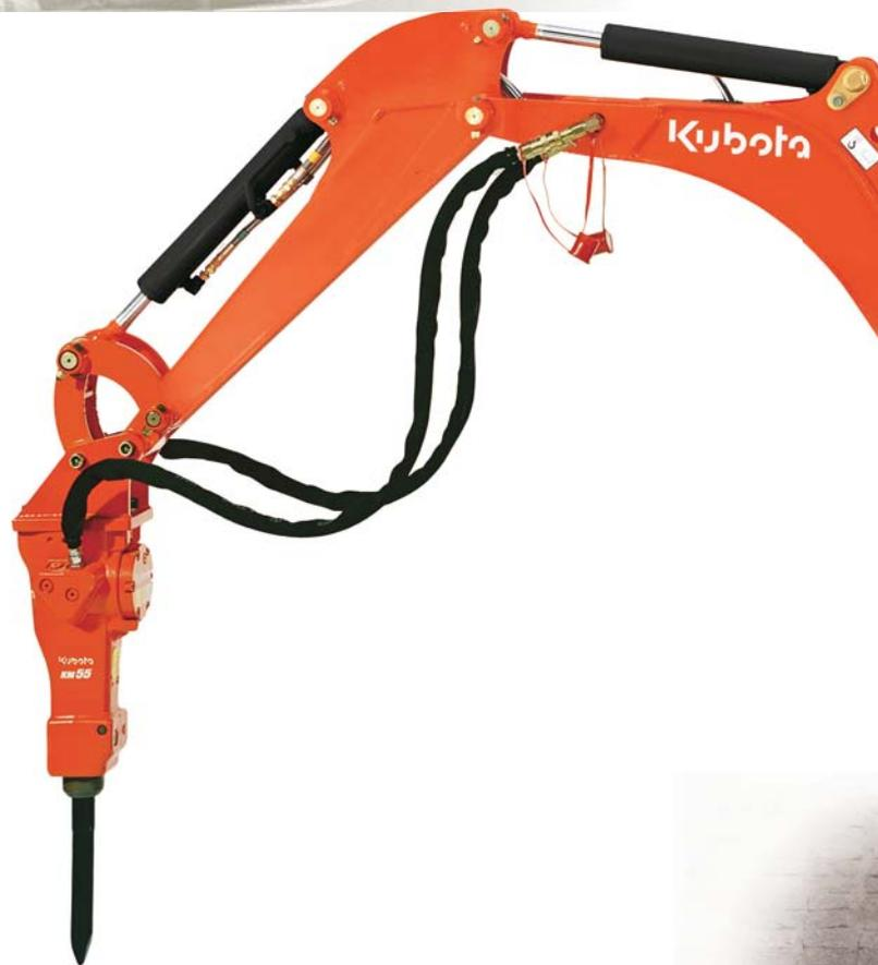
Flexibles hydrauliques du circuit auxiliaire
